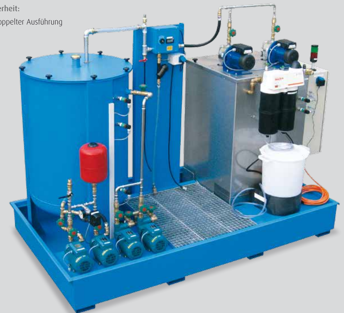
Mischanlage für Trennmittel mit Wasserenthärtungs- anlage, Wasservorlagebehälter aus Edelstahl. Misch- gerät Mini digital 3000 und Gemischvorlagebehälter in runder Ausführung zur kontinuierlichen Umwälzung.
